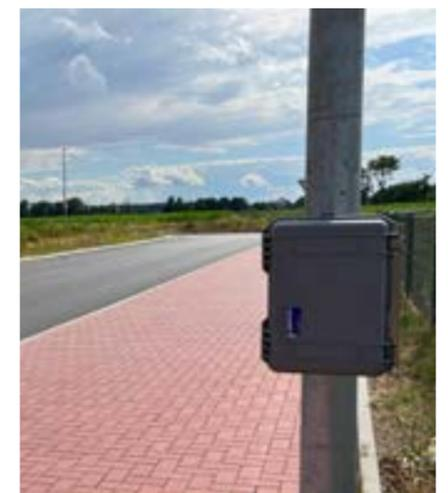
Abb. 1-4 Seitenradargerät zur Verkehrserfassung
